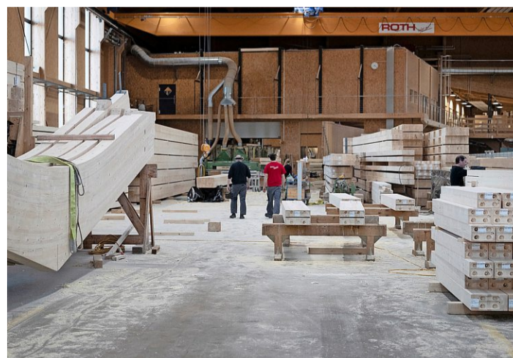
Bei der Roth AG, werden Holzträger gefräst – dadurch entstehen täglich mehrere Tonnen Holzspäne.
